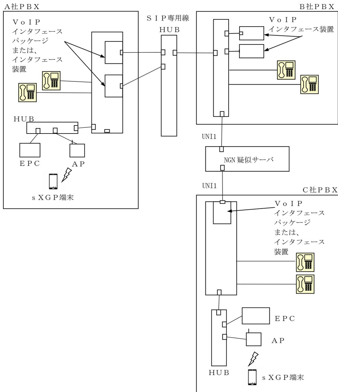
図 3-6 タンデム接続試験 (SIP 専用線-NGN)
