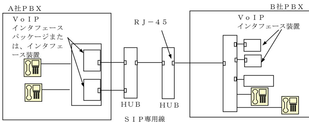
図 3-1 SIP 相互接続試験接続図
