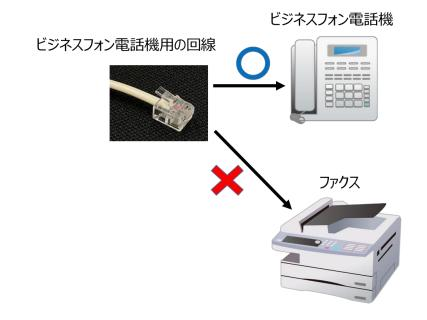
ビジネスフォン電話機に使用されるコネクタ(モジュラージャック)は、 一般の電話回線で使用されているものと形状が同じであるため、 外観では全く見分けがつきません。
