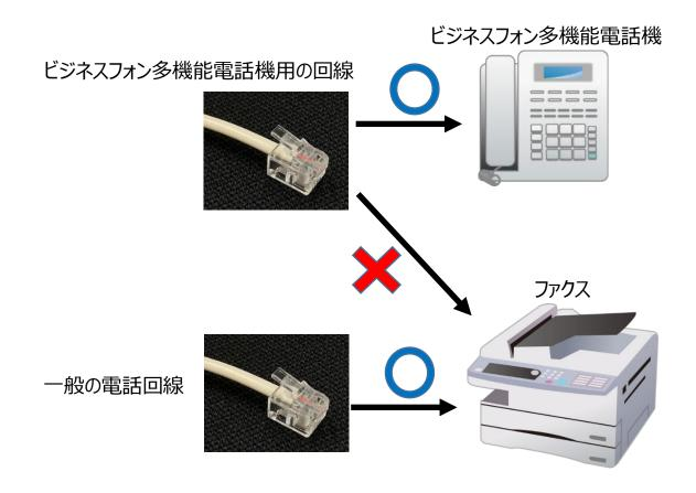
ビジネスフォン多機能電話機に使用されるコネクタ(モジュラージャック)は、一般の電話回線で使用されているものと形状が同じであるため、外観では全く見分けがつきません。
