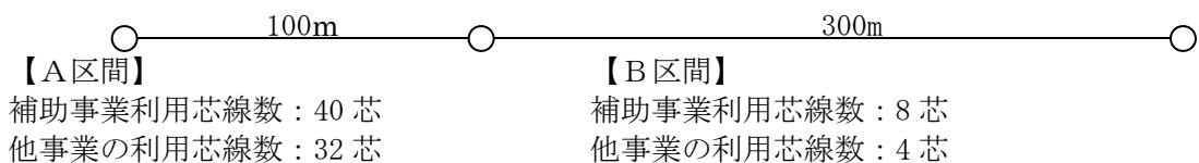
$$\bullet \text{補助事業距離換算値} = \frac{40 \text{ 芯}}{40 \text{ 芯} + 32 \text{ 芯}} \times 100m + \frac{8 \text{ 芯}}{8 \text{ 芯} + 4 \text{ 芯}} \times 300m = 255.6m$$
