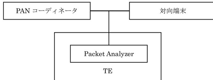
図 4-6-3 G3-PLC 接続試験の環境 (Multicast 相互接続)
