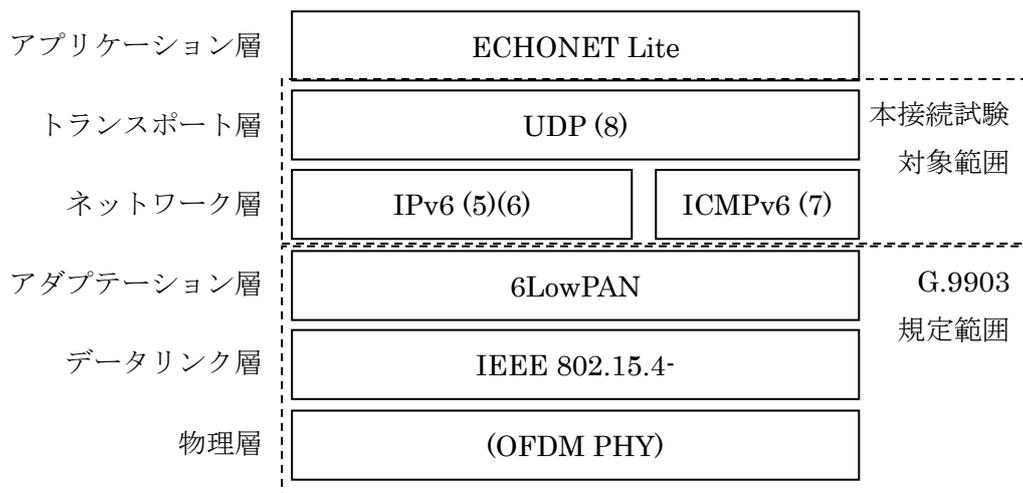
図 3-1-1 G3-PLC 通信端末プロトコルスタック
