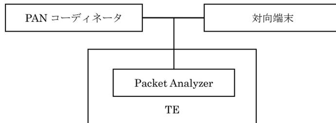
図 4-6-2 G3-PLC 接続試験の環境 (Unicast 相互接続)
